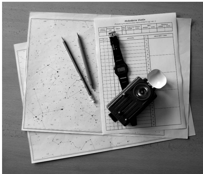
Základní pomůcky k vizuálnímu pozorování meteorů: tužky, hodinky (nejlépe digitální), baterka s červeným světlem, protokoly na zápis meteorů a mapy hvězdné oblohy (Foto E. Březina)
