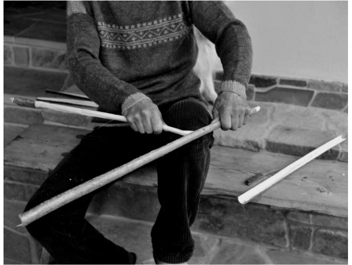
■ Vytrhávání jádra lískového prutu / obr. 3 (Foto V. Bjaček, 2013)
